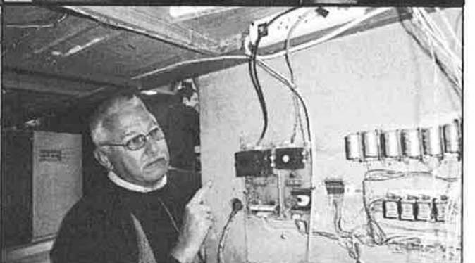
Poursuite des travaux sur le réseau HO mosan : réalisation d'un TCO pour les voies en gare de Hun. Le TCO et ses commandes. En bas : derrière le décor, la technique électrique réalisée par Patrick.
